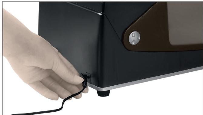
Priklučite kraj pneumatskog konektora u vazdušni konektor na zadnjoj strani modula, a zatim povežite vrh pneumatskog konektora sa dovodom za vazduh. Podesite vazdušni pritisak dovoda za vazduh na 5–10 bara.
